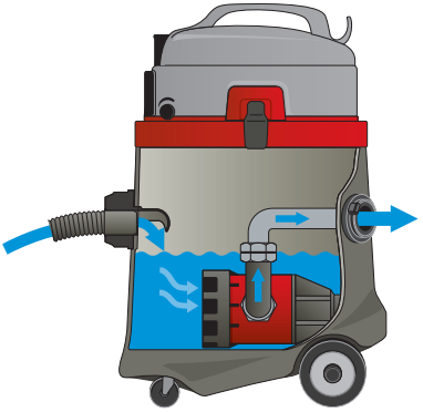
Funktionsprinzip: Wasser wird durch den Schlauch des Saugers angesaugt. Die integrierte Schmutzwasserpumpe fördert das gesammelte Wasser sofort durch den hinten am Gerät angebrachten C-Rohr-Anschluss weiter.
