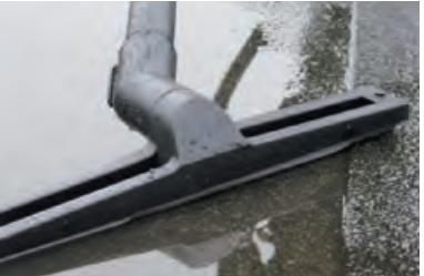
Die 360 mm breite Nassbodendüse im Einsatz auf dem Flachdach.
