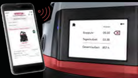
Auslesen/Synchronisieren von Gerätedaten über Bluetooth-Schnittstelle.
